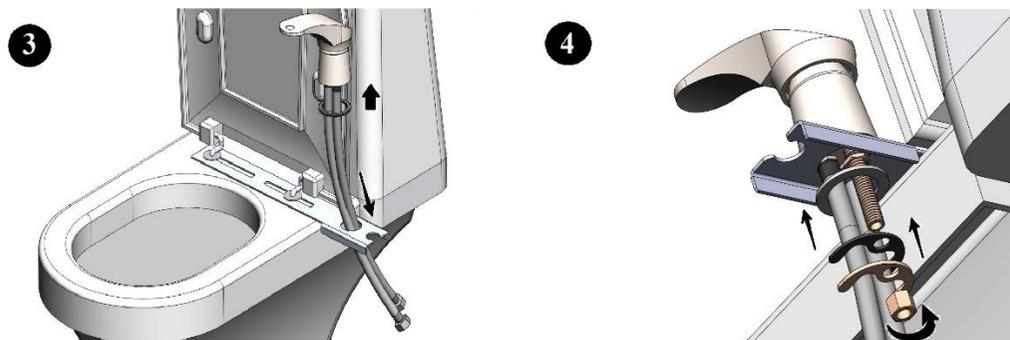
5. Установите кольцо (диск) фиксации, продев сквозь него гибкую подводку, наложите на него резиновую прокладку и латунную полушайбу, затяните все фиксирующей гайкой M12 (Рис.4)
