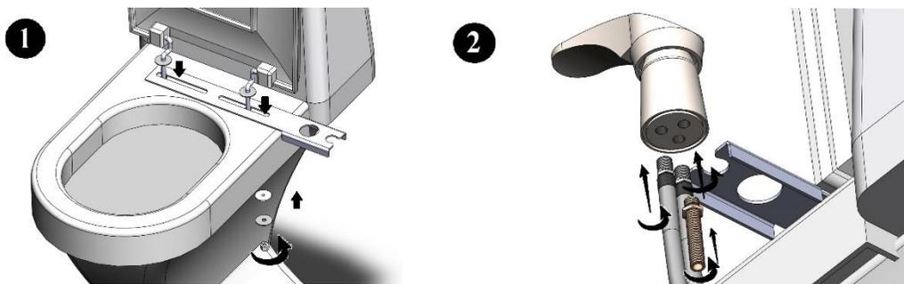
2. Установите кронштейн под крепление унитаза, надежно зафиксируйте. (Рис.1)
